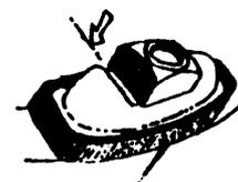
12. Затягивая болты, позаботьтесь, чтобы резина уплотнительного элемента расширялся сначала с внешней стороны (по направлению к стене или гильзе). Только тогда, уплотнительное кольцо начнет расширяться внутрь.
